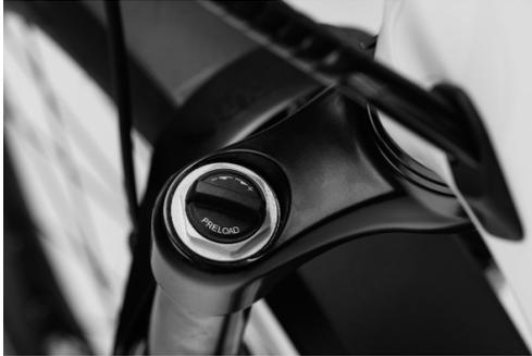
Fig. 17: Tornillos de ajuste de la carga previa de la horquilla de suspensión
