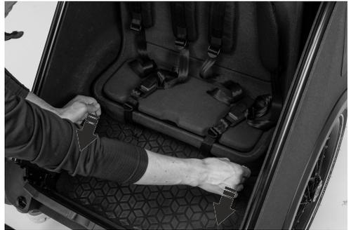
Fig. 37: Pestillo tirado hacia delante (abierto)
