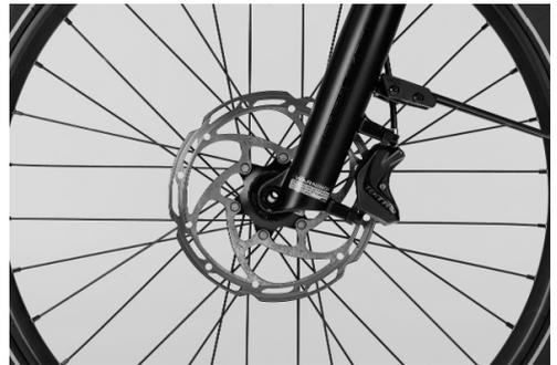
Fig. 1: Disco de freno en la rueda delantera
