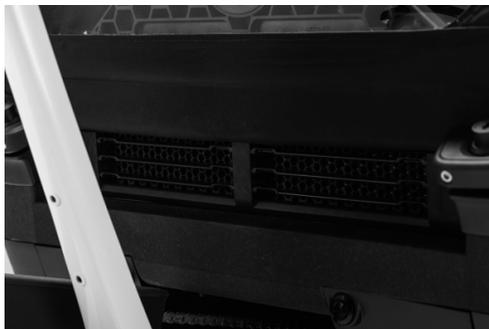
Fig. 18: Ranuras de ventilación de la caja
