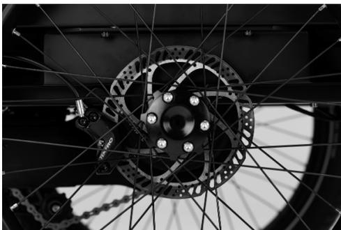
Fig. 2: Disco de freno en la rueda trasera
