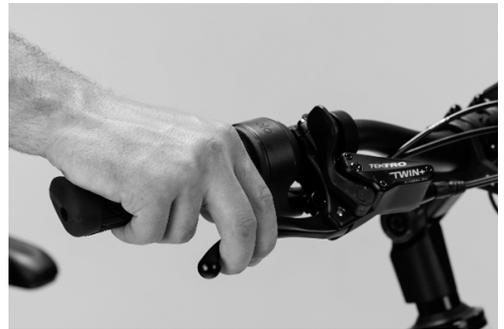
Fig. 11: Palanca de freno completamente accionada
