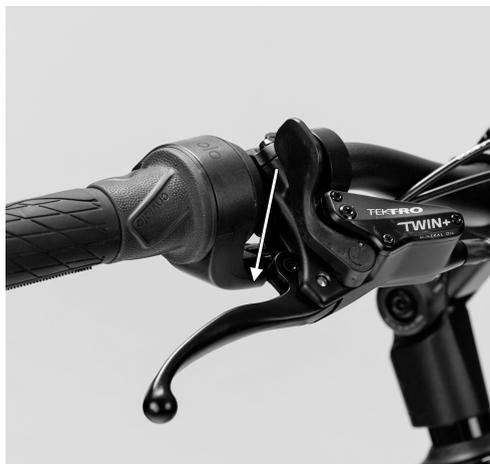
4. → Gire la palanca hasta oír un clic y hasta que quede enclavada. De este modo, la palanca más pequeña se separa de la palanca más grande y la enclava.
