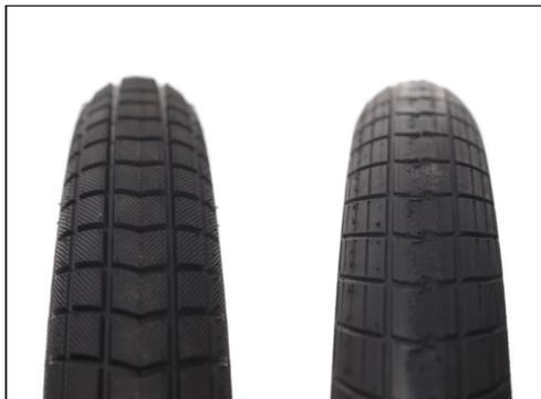
Fig. 8: Perfil óptimo de la cubierta (izquierda); perfil desgastado de la cubierta (derecha)
