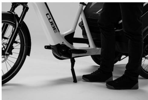
3. → Active la función de estacionamiento del freno de la rueda trasera. Para ello, gire la más grande de las dos palancas alejándola del manillar. La palanca más pequeña se despliega automáticamente.
