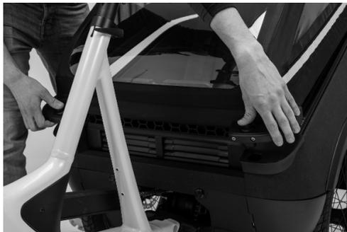
Fig. 19: Botones pulsados: cubierta ligeramente abierta
