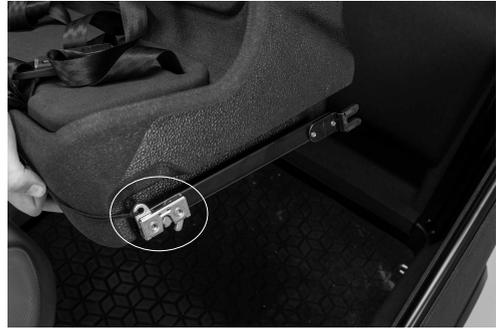
Fig. 31: Pestillo del raíl tirado hacia delante, cierre abierto
