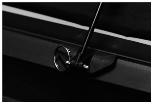
Fig. 49: Pasador dividido con botón de seguridad
