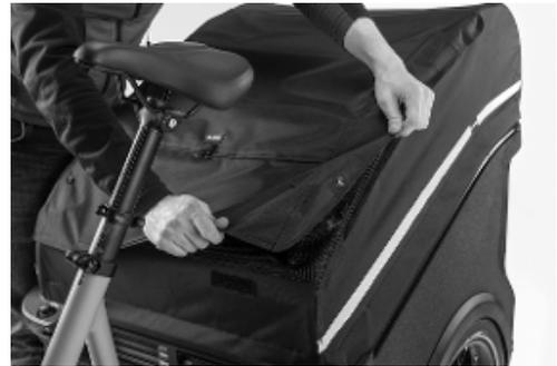
Fig. 57: Fije la lona a la cubierta
