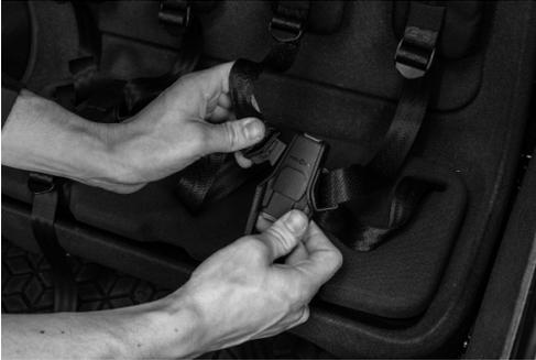
Fig. 35: Insección de las hebillas del cinturón en el cierre
