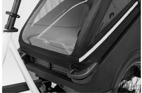
Fig. 6: Cubierta cerrada, llave en la cerradura
