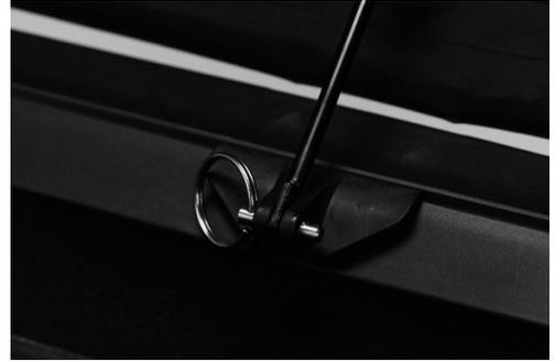
Fig. 27: Pasador dividido con botón de seguridad
