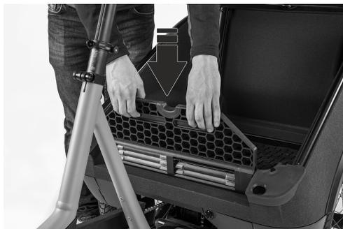
Fig. 47: Presionar el estribo hacia abajo hasta la posición de enclavamiento
