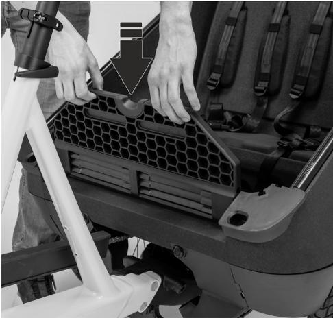
Fig. 25: Presionar el estribo hacia abajo hasta la posición de enclavamiento
