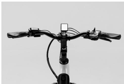
Fig. 4: Manillar con potencia
