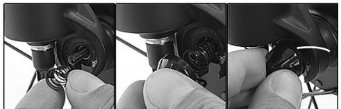
3. Bei Schnellspannhebel zur Sattelstützenklemmung: Drehen Sie anstatt der Mutter die Schraube selbst am Innensechskant im Uhrzeigersinn.
