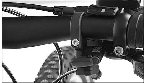
2. **Verfügt Ihre Gabel über einen Feststellmechanismus, wie auf dem Bild zu sehen, entnehmen Sie dessen Bedienung der beiliegenden Komponentenbetriebsanleitung des Federgabelherstellers.**
