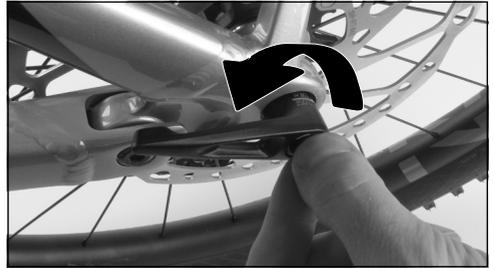
4. Wenn Sie die Achse ausreichend angezogen haben, dann bringen Sie den Hebel in eine in Fahrtrichtung nach Vorzeigende Position und schieben den Hebel auf die Achse auf. Drehen Sie nun die Sicherungsschraube um 180° mit dem Uhrzeigersinn wieder zu, um den Hebel gegen selbstständiges Drehen zu sichern.
