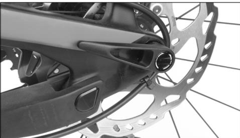
Sie können den Hebel nun ein Stück von der Achse abziehen und können den Hebel in eine beliebige Position rotieren. Um die Achse weiter festzuziehen, können Sie den Hebel in einer günstigen wieder zurück auf die Achse schieben und erneutes Drehmoment aufbringen.
