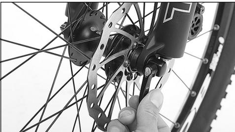
2. Drehen Sie die Schraubenmutter soweit gegen den Uhrzeigersinn bis sich das Laufrad ohne großen Kraftaufwand aus dem Rahmen bzw. aus der Vorderradgabel nehmen lässt.
