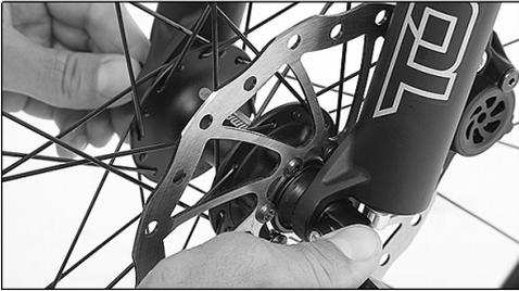
5. Drehen Sie die Schraubenmutter bzw. den Innensechskant nun soweit, bis sich der exzentrisch gelagerte Hebel bei einer Drehung um seine Lagerung ab 90° nur noch gegen einen Widerstand bewegen lässt (er bildet so die ungefähre, geradlinige Verlängerung der Nabenachse).
