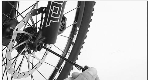
2. Setzen Sie die Feder und die Schraubenmutter auf die Achse. Drehen Sie auf das rechte Ende, das jetzt aus der Nabe heraussteht, die Schraubenmutter im Uhrzeigersinn.
