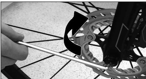
3. Anschließend bringen Sie mit einem Drehmomentschlüssel den Vorgabewert des Herstellers auf, jedoch niemals mehr als 16Nm.
