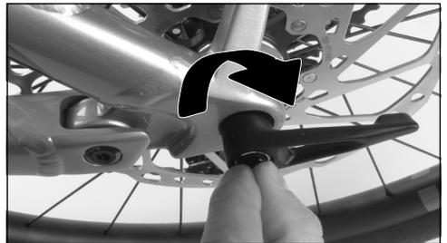
5. Zum Lösen der Achse können Sie direkt den Hebel nutzen und drehen im Gegenuhreigersinn. Sollten Sie in der Hebelposition nicht genügend Kraft aufwenden können, dann gehen Sie die Schritte 1 bis 4 rückwärts durch. So können Sie den Hebel in eine Position bringen, um das Lösen zu vereinfachen.
