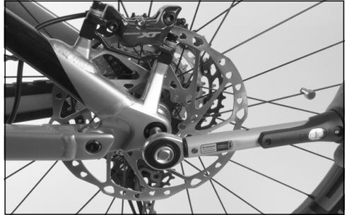
4. Für den Ausbau müssen sie die Steckachse mit einem Inbusschlüssel heraus-schrauben.
