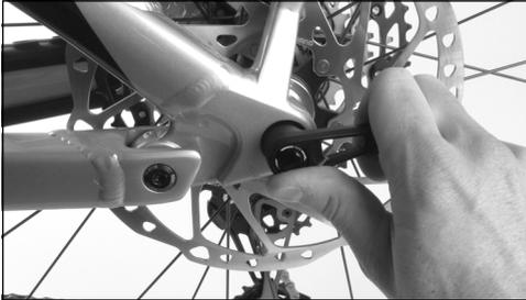
2. Bringen Sie mit Hilfe des Hebels und starker Handkraft die Achse zum festen Sitz. Ein vergleichbares Drehmoment von 16Nm sollte nicht überschritten werden.
