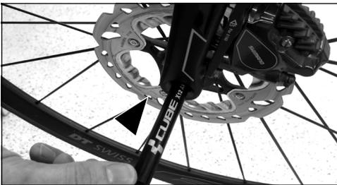
2. Befestigen Sie die Steckachse handfest mit einem Inbusschlüssel.
