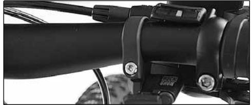
2. **Se la forcella dispone di un meccanismo di fissaggio, come si vede dalla figura, leggerne il funzionamento sul manuale d'istruzioni allegato, relativo ai componenti, fornito dal produttore della forcella ammortizzata.**
