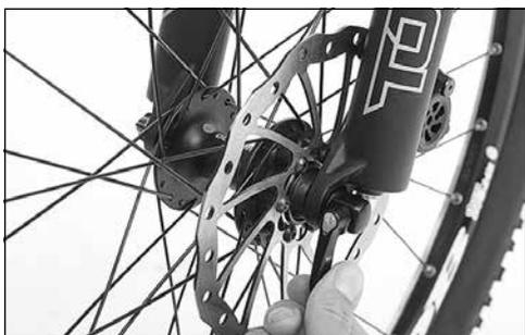
2. Ruotare il dado a vite in senso antiorario finché è possibile rimuovere la ruota, senza grandi sforzi, dal telaio e/o dalla forcella anteriore.
