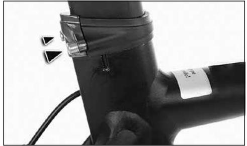
Per il serraggio senza leva a sgancio rapido, è necessario usare una chiave a brugola e una chiave dinamometrica per ciascuna delle dimensioni. A tal proposito consultare anche il proprio rivenditore specializzato.
