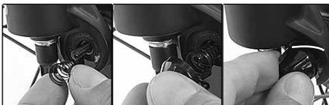
3. In presenza di leva a sgancio rapido per il bloccaggio del reggisella: non ruotare il dado bensì la vite stessa dalla testa esagonale in senso orario.
