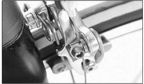
**2. Controllare il corretto fissaggio e serraggio a vite di tutto l'impianto frenante:**
