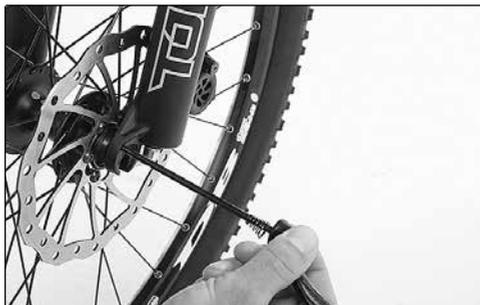
2. Posizionare le molle e il dado a vite sull'asse. Dall'estremità destra, che ora fuoriesce dal mozzo, ruotare il dado a vite in senso orario.
