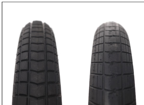
Fig. 8: profilo ottimale del copertone (sinistra); profilo del copertone consumato (destra)
