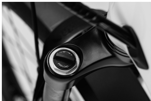
Fig. 17: Vite di regolazione del precarico della forcella ammortizzata
