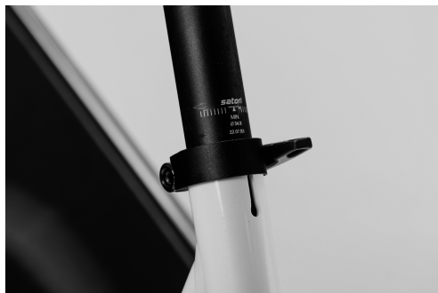
Fig. 14: indicazione della profondità d'inserimento minima del canotto della sella
