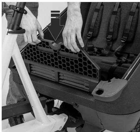
Fig. 25: spingere il predellino verso il basso bloccandolo
