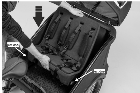
Fig. 33: premere il seggiolino per bambini fino a bloccarlo
