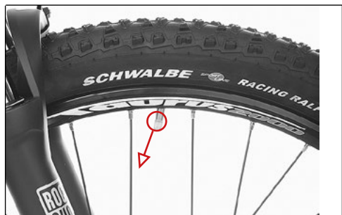
La valve ne pointe pas vers le centre de la roue
