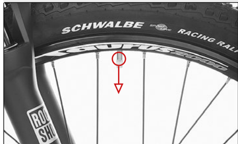
La valve pointe vers le centre de la roue
