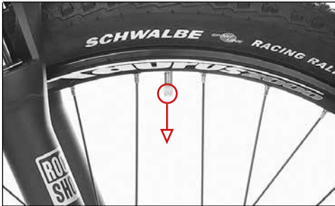
Ventil zeigt zum Laufradmittelpunkt
