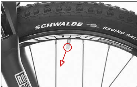
Ventil zeigt nicht zum Laufradmittelpunkt
