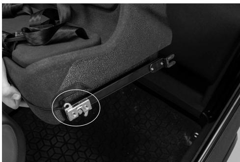
Fig. 31 : loquet sur rail tiré vers l'avant, verrouillage ouvert
