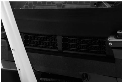
Fig. 18 : orifices de ventilation de la caisse
