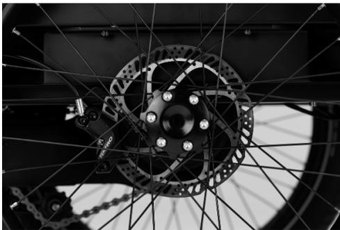
Fig. 2 : Disque de frein de la roue arrière
