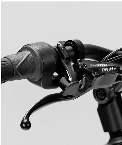
2. ➤ Pour le repliage, tirez complètement les deux leviers vers l'arrière en direction du guidon.
