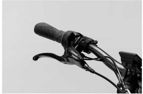
Fig. 3 : Levier de frein sur le guidon
