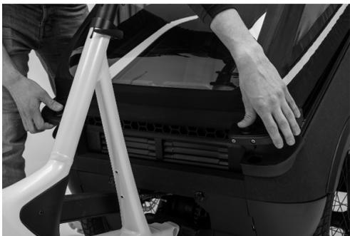
Fig. 19 : boutons enfoncés, capote légèrement ouverte
