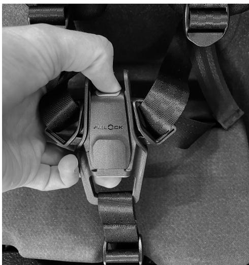
Fig. 36 : ouvrir le système de ceinture
