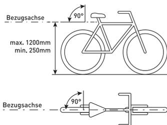
Überprüfen Sie regelmäßig die richtige Einstellung und Anbauhöhe Ihres Rücklichtes. Das Rücklicht muss in einem Bereich von 250 bis 1200 mm über der Fahrbahn montiert werden. Es muss so angebauet und eingestellt werden, dass die Bezugsachse parallel zur Fahrzeuglängsmitttelebene und parallel zur Fahrbahn liegt (siehe Abbildung).
