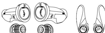
3. Observar la disposición correcta del puño/acople bar end izquierdo y derecho (marcación en el interior). Suelte 3-4 vueltas el tornillo de apriete.
