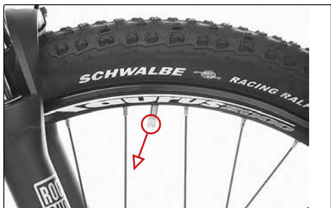
Ventil peger ikke mod hjulets midte
