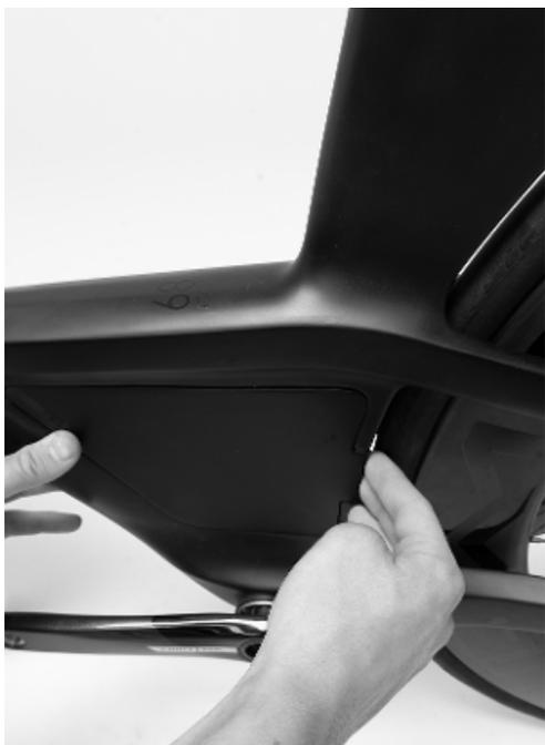
3. → Führen Sie die Schläuche vom Oberrohr durch das Unterrohr zur In-Frame Hydration, die am Tretlager positioniert ist.
