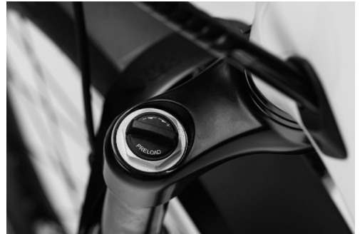
Fig. 17: Vite di regolazione del precarico della forcella ammortizzata
