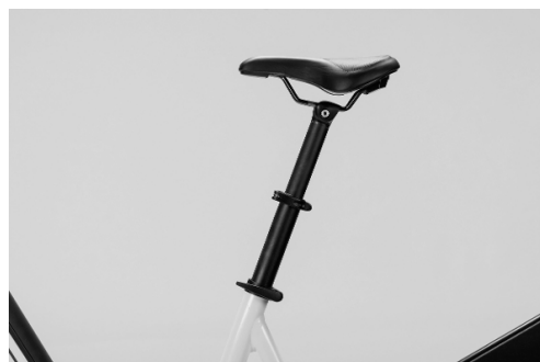
Fig. 16: bloccaggio rapido della sella fissato
