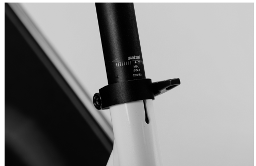
Fig. 14: indicazione della profondità d'inserimento minima del canotto della sella
