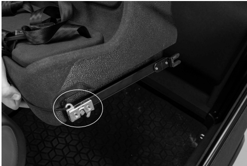
Fig. 31: Dispositivo di arresto tirato in avanti sul binario, blocco aperto
