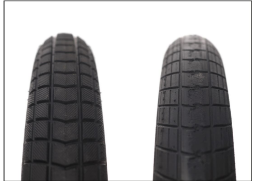
Fig. 8: profilo ottimale del copertone (sinistra); profilo del copertone consumato (destra)
