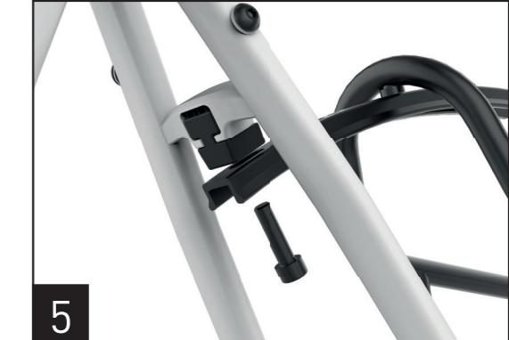
5. Verschrauben Sie anschließend das Langloch der Unterlaufstrebe mit der Sitzstrebengelenkbrücke des Rahmens. Verwenden Sie hier die M6x20mm Inbusschraube (B).
