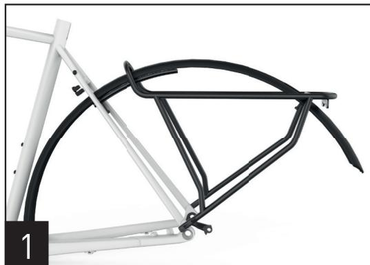
1. Setzen Sie den Träger auf die Schnittstelle des Rahmens. Achten Sie auf eine horizontale Ausrichtung des Trägers und markieren Sie sich die beiden Montagepunkte des Gepäckträgers mit einem Stift am Schutzblech. Bohren Sie anschließend mit einem 7mm Bohrer mittig an den von Ihnen markierten Punkten durch das Schutzblech. Ist noch kein Schutzblech montiert, muss dieses auch an der Sitzstrebengelenkposition gebohrt werden!
