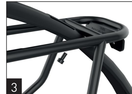
3. Verbinden Sie das hintere Ende des Gepäckträgers mit dem Schutzblech. Verwenden Sie hierzu die mitgelieferte M5x10mm Inbusschraube (C).
