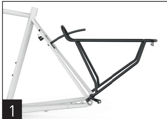
1. Setzen Sie den Gepäckträger mit dem Ausfall-Ende auf die Schnittstelle des Rahmens und achten Sie auf eine horizontale Ausrichtung des Trägers. Markieren Sie sich den Montagepunkt an der Unterlaufstrebe (A) mit einem Stift oder einem Stück Klebeband.
