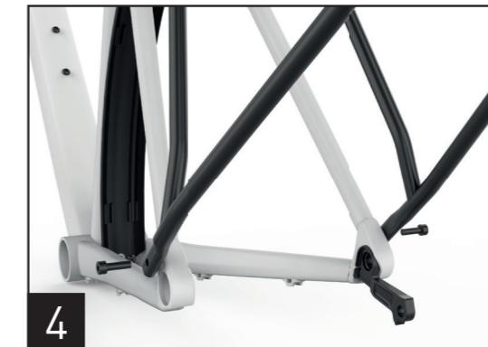
4. Verschrauben Sie die Ausfallenden des Trägers mit den Schnittstellen des Rahmens. Verwenden Sie dazu die mitgelieferten M5x16mm Inbusschrauben (E).
