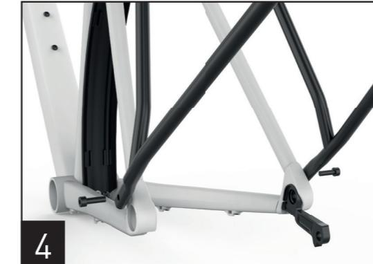
4. Verschrauben Sie die Ausfallenden des Gepäckträgers mit den Schnittstellen des Rahmens. Verwenden Sie dazu die mitgelieferten M5x16mm Inbusschrauben (E).
