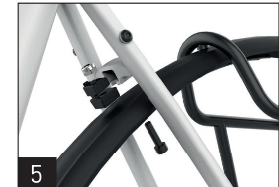
5. Verschrauben Sie anschließend die Gepäckträger-Schutzblech-Einheit über das Langloch der Unterlaufstrebe mit der Sitzstrebengelenkbrücke des Rahmens. Verwenden Sie hierzu die mitgelieferte M6x25mm Inbusschraube, den Einsatz-Adapter und die selbstsichernde M6 Mutter (B).
