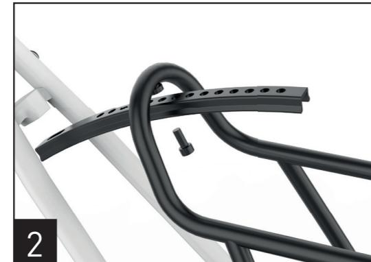
2. Verschrauben Sie den vorderen Montagepunkt des Gepäckträgers mit der Unterlaufstrebe (A) am von Ihnen markierten Montagepunkt mit der mitgelieferten M5x14mm Inbusschraube (D).
