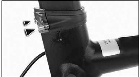
En caso de un mecanismo de apriete sin eje de liberación rápida, necesita una llave hexagonal y un llave dinamométrica de tamaño adecuado respectivo. Consulte para ello a su distribuidor especializado.
