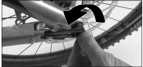
4. Cuando haya apretado el eje lo suficiente, mueva la palanca a una posición orientada hacia adelante en la dirección de la marcha y empuje la palanca sobre el eje. Después, vuelva a apretar el tornillo de bloqueo 180° en el sentido de las agujas del reloj para asegurarse de que la palanca no gire por sí sola.
