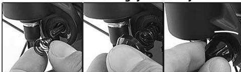
3. En caso de la palanca de liberación rápida en el mecanismo de apriete de la tija del sillín: gire el tornillo hexagonal en vez de la tuerca en el sentido de las agujas del reloj.
