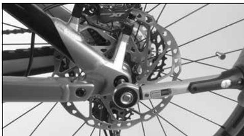
4. Para el desmontaje, desenrosque el eje pasante con una llave Allen.
