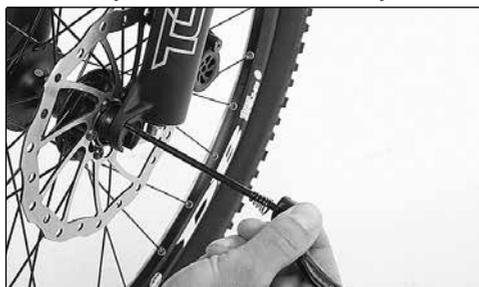
2. Coloque los muelles y la tuerca de tornillo en el eje.
