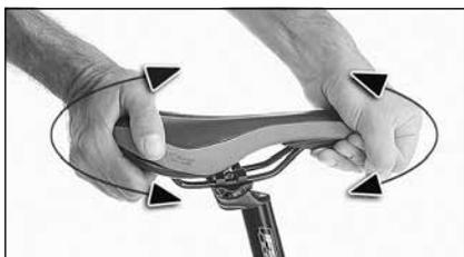
Intente mover en su mecanismo de apriete el sillín mediante movimientos hacia arriba y hacia abajo con la fuerza de la mano.
