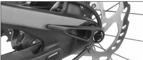
Para apretar más el eje, puede empujar la palanca de nuevo hacia el eje en la posición deseada y aplicar un nuevo par de apriete.
