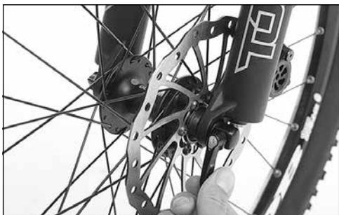
2. Gire la tuerca de tornillo en sentido contrario a las agujas del reloj hasta que la rueda se pueda sacar del cuadro o de la horquilla sin demasiado esfuerzo.
