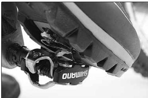
C) Cuando la punta del gancho se encuentra en la posición correcta en el pedal, pise con un fuerte tirón con toda la superficie del pie hacia abajo hasta que oiga que el mecanismo de apriete encaja.
