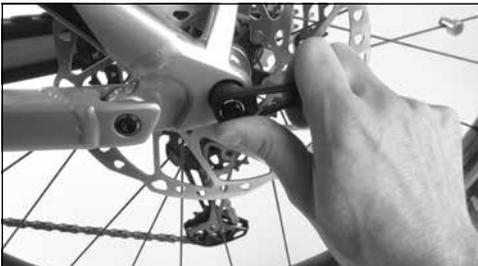
2. Ajuste bien el eje con ayuda de la palanca y ejerciendo fuerza con las manos. La fuerza no debe superar la equivalente a un par de apriete de 16 Nm.
