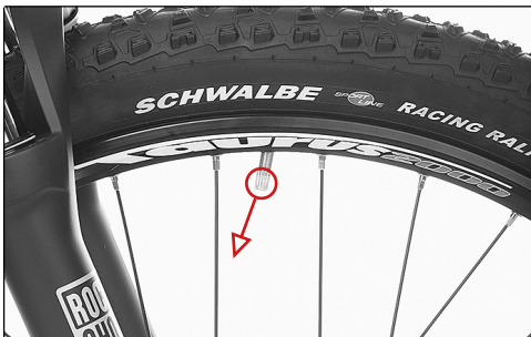
Ventil zeigt nicht zum Laufradmittelpunkt
