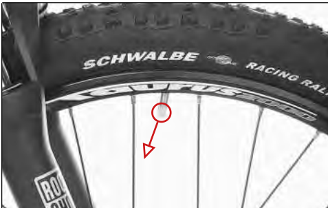
Ventil zeigt nicht zum Laufradmittelpunkt
