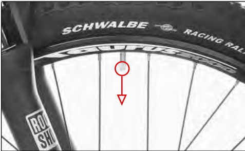
Ventil zeigt zum Laufradmittelpunkt
