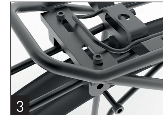
3. Lösen Sie die Schrauben der Besfestigungen für die oberen Verbindungsstreben. Drehen Sie diese jedoch nicht komplett heraus.
