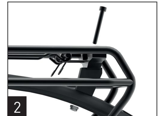
2. Verbinden Sie das hintere obere Ende des Gepäckträgers mit dem Schutzblech. Verwenden Sie hierzu den mitgelieferten Adapter (siehe Übersicht!). Hierzu muss ein Loch mit 7mm Durchmesser in das Schutzblech gebohrt werden. Mittigkeit der Bohrung beachten!
