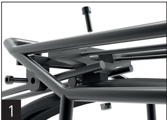
1. Verbinden Sie das obere vordere Teil des Gepäckträgers mit Hilfe des mitgelieferten Adapters (siehe Übersicht!) mit dem Schutzblech. Hierzu muss ein Loch mit 7mm Durchmesser in das Schutzblech gebohrt werden. Mittigkeit der Bohrung beachten!
