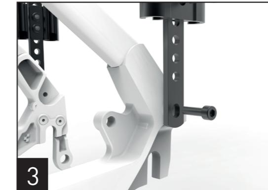
3. Schrauben Sie die beiden unteren Enden des Gepäckträgers an das Ausfallende des Fahrradrahmens. Verwenden Sie hierzu die Schrauben M5x16mm.
