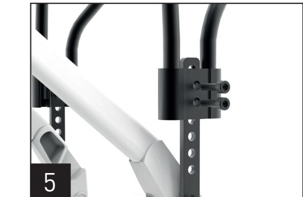
4.2 Schrauben Sie die beiden unteren Enden des Gepäckträgers an das Ausfallende des Fahrradrahmens. Verwenden Sie hierzu die Schrauben M5x16mm.
