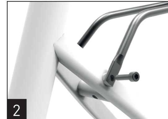
2. Schrauben Sie die oberen Verbindungsstreben an die vorhergesehenen Rahmen-Anschraubpunkte. Verwenden Sie hierzu die mitgelieferten Schrauben M5x16mm.
