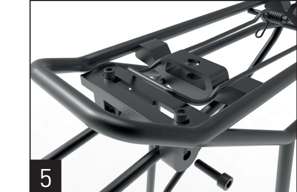
5. Richten Sie den Gepäckträger horizontal aus und ziehen Sie alle Schrauben an den oberen Strebenbefestigungen fest. Gegebenenfalls müssen bei großen Rahmengrößen die oberen Einstellstreben gekürzt werden um eine optimale Anpassung an das Rad zu gewährleisten.
