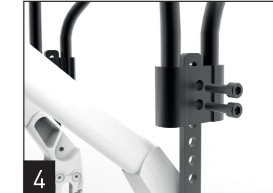
4. Passen Sie die Höhe des Gepäckträgers an die Radgröße ihres Fahrrads an. Lösen Sie hierfür die M5x16mm Schrauben von den M5 Muttern und schieben Sie anschließend den Gepäckträger in die passende Höhe.
