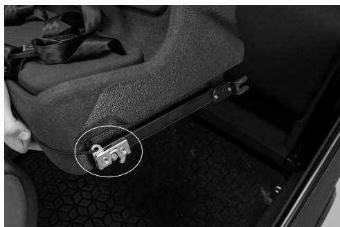
Fig. 31 : Verrou sur le rail tiré vers l'avant, verrouillage ouvert
