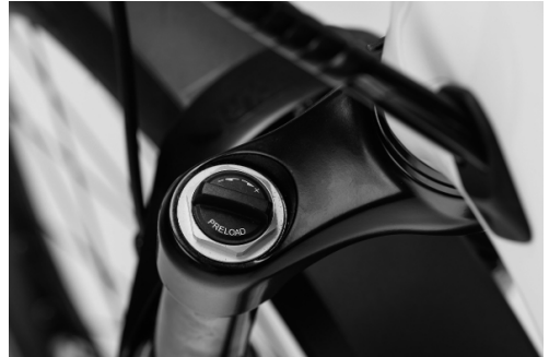
Fig. 17 : vis de réglage de la précontrainte de la fourche suspendue
