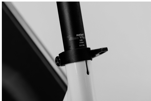
Fig. 15 : Longueur d'insertion minimale de la tige de selle
