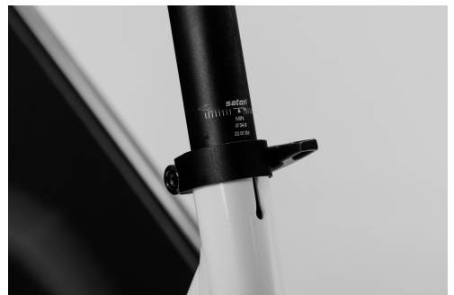
Fig. 14 : Repère de la longueur d'insertion minimale sur la tige de selle
