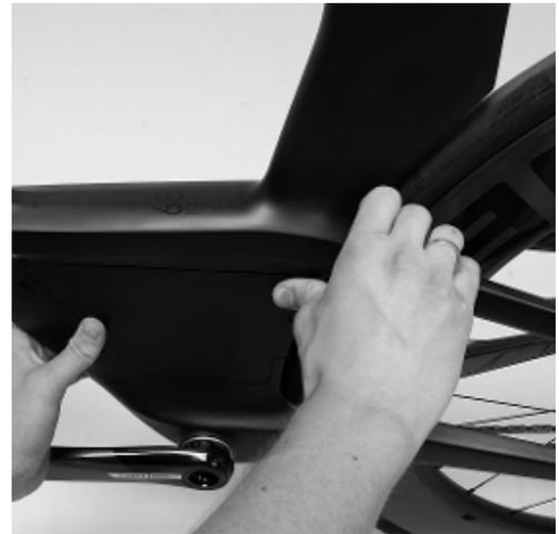
7. → Instale el tapón necesario en el tubo superior, en función de la opción de montaje seleccionada.
