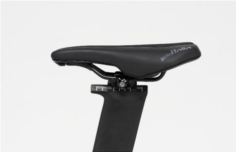
Para fijar el sillín de forma segura y sencilla, utilice la abrazadera Ritchey de 1 tornillo incluida en el volumen de suministro. Además de la abrazadera de 7x7 mm para vainas superiores estándar, también se incluye una abrazadera de 7x9,6 mm para vainas superiores de carbono sobredimensionadas para el montaje de diferentes modelos de sillín.
