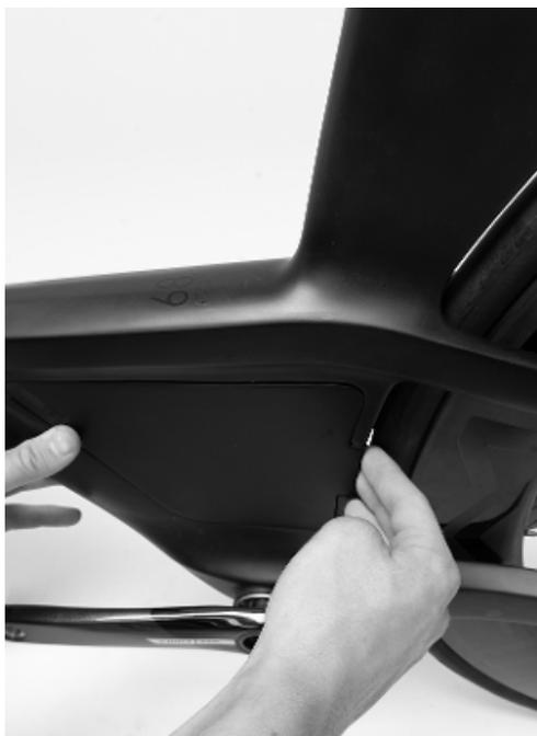
**3.** → Pase los tubos desde el tubo superior a través del tubo inferior hasta el sistema de hidratación integrado, situado en el eje de pedalier.
