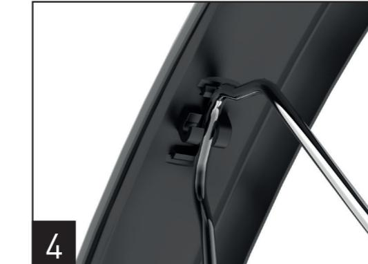
**4.** Setzen Sie die Strebe mittig von innen in den Streben-Adapter. Durch 90 Grad drehen rastet die Strebe im Streben-Adapter ein. (Nur bei Set mit Streben!).
