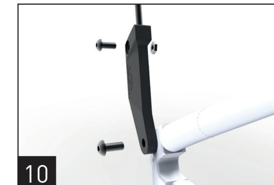
**10. Stecken Sie die hinteren Streben-Adapter auf die Strebe und fixieren Sie diese mit der M4x6mm Schraube und M4 Mutter. Verschrauben Sie anschließend die Streben-Adapter mit der M5x12mm Schraube mit dem Rahmen am dafür vorgesehenen Gewinde. (Nur bei Set mit Streben!).**
