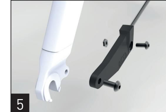
**5.** Stecken Sie den Gabel-Adapter auf die Strebe und fixieren Sie diese mit der M4x6mm Schraube und M4 Mutter. Schrauben Sie den Adapter mit der M5x12 Schraube an das dafür vorgesehene Gewinde am unteren Ende der Gabel (Nur bei Set mit Streben!).
