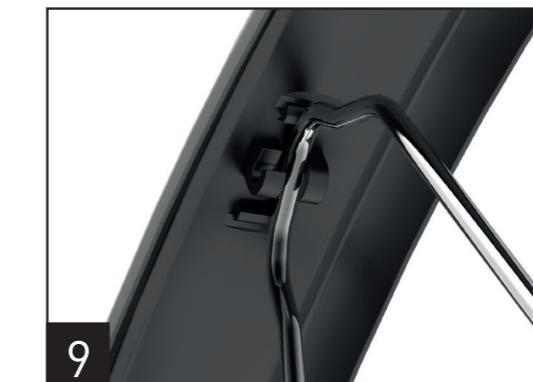
**9. Setzen Sie die Strebe mittig von innen in den Streben-Adapter. Durch 90 Grad drehen rastet die Strebe im Streben-Adapter ein. (Nur bei Set mit Streben!).**
