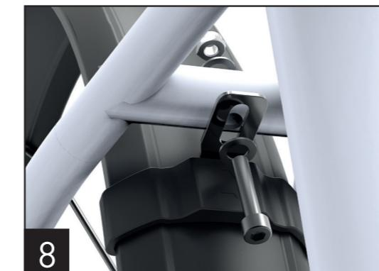
**8.2 Setzen Sie den Brücken-Adapter auf das Schutzblech und verschrauben Sie diesen an der Sitzstreben-Brücke mit der M5x25mm Schraube, der beiden M5 Unterlegscheiben und der M5 Mutter.**
