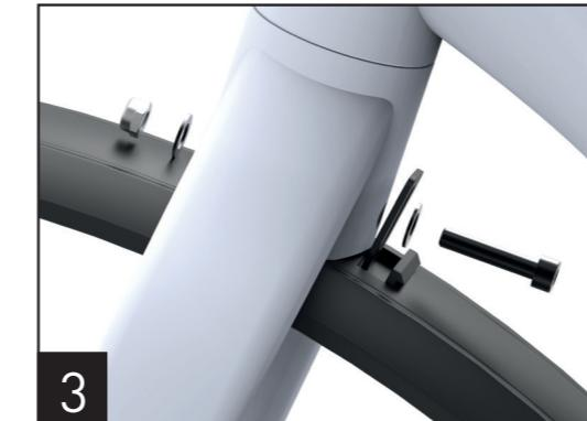
**3.** Befestigen Sie das Schutzblech mit der mitgelieferten M6x45mm Schraube, zwei M6 Unterlegscheiben und der M6 Mutter an der Gabelbrücke.
