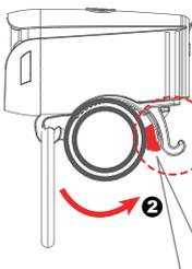
2. Falten Sie die Gummieinlage nach innen, um die Lücke zwischen der Halterung und dem Lenker zu schliessen, bevor Sie den Gummiring benutzen.
