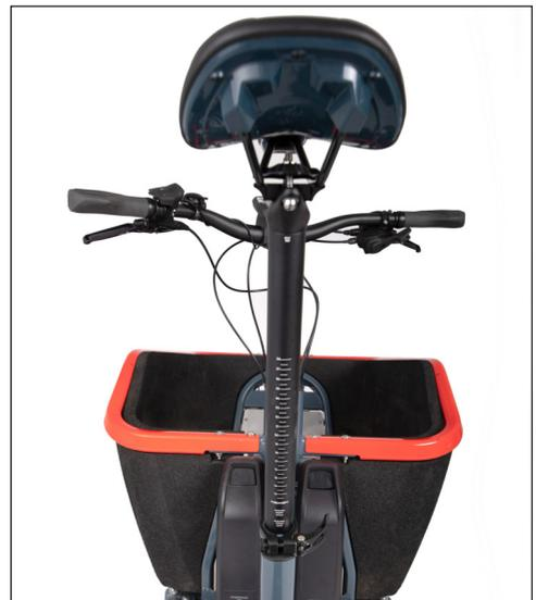
**Bild:** Adjusting the seat height
