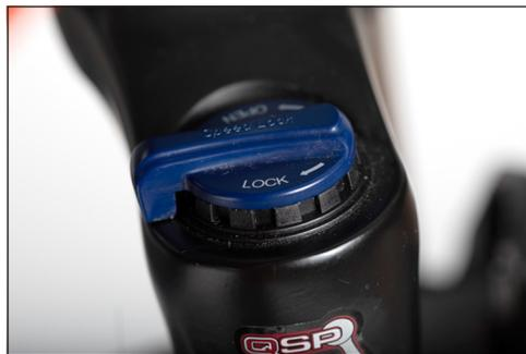
**Bild:** Suspension fork locked (=LOCK)
