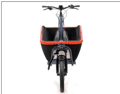
**Bild:** Stem and handlebars correctly aligned
