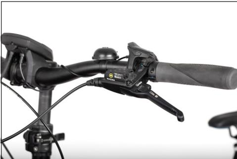
**Bild:** Brake lever on the handlebars
