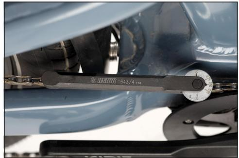
**Bild:** Chain wear gauge
