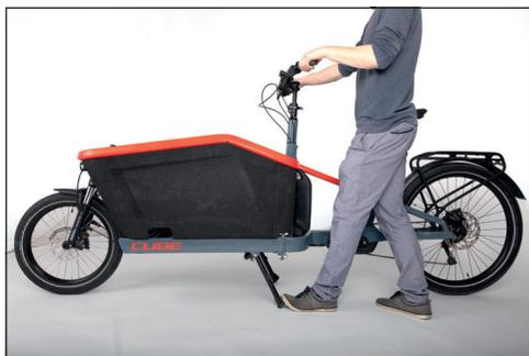
**Bild:** Folding out the kickstand
