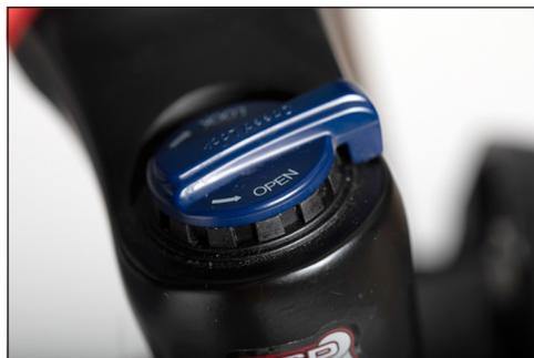
**Bild:** Suspension fork open (=OPEN)
