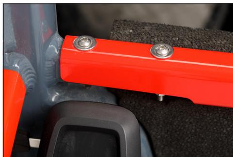
**Bild:** Front box screw connections
