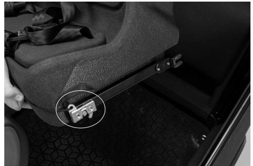
Abb. 31: Riegel an Schiene nach vorne gezogen, Verriegelung geöffnet
