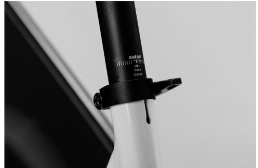
Abb. 14: Markierung für die Mindesteinstecktiefe der Sattelstütze
