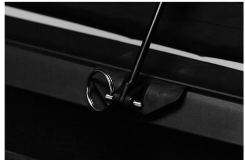
Abb. 27: Splint mit Sicherheitsknopf
