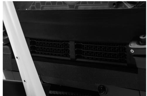
Abb. 40: Belüftungsöffnungen Box
