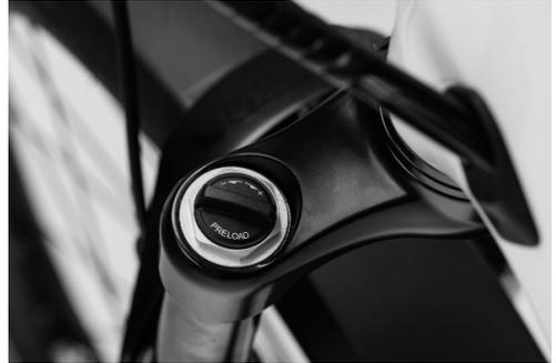
Abb. 17: Einstellschrauben Vorspannung Federgabel
