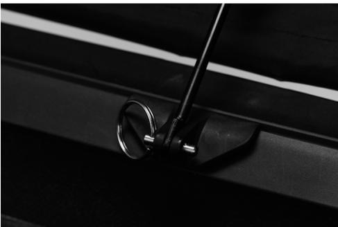
Abb. 52: eingesetzter Splint
