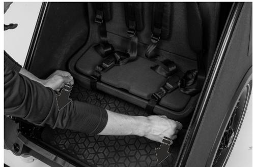
Abb. 37: Riegel nach vorne gezogen (geöffnet)
