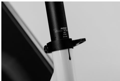
Abb. 15: Mindesteinstecktiefe Sattelstütze
