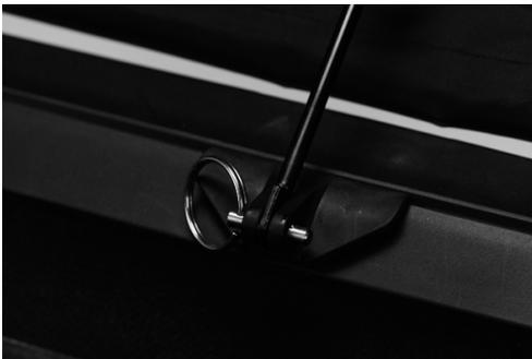
Abb. 30: eingesetzter Splint
