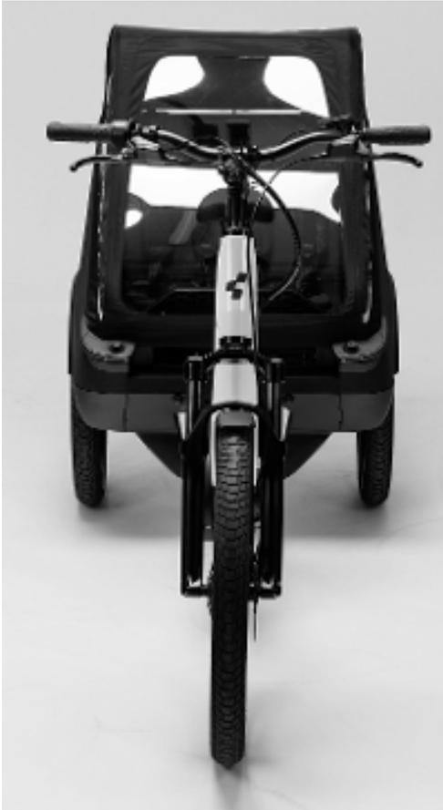
Abb. 9: Lenkervorbau und Lenker ausgerichtet
