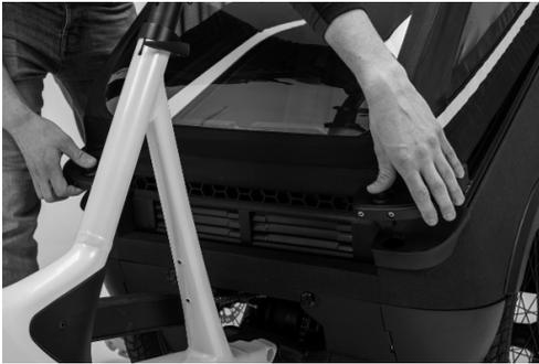
Abb. 19: gedrückte Knöpfe - Verdeck leicht geöffnet
