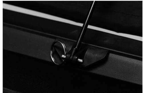
Abb. 49: Splint mit Sicherheitsknopf
