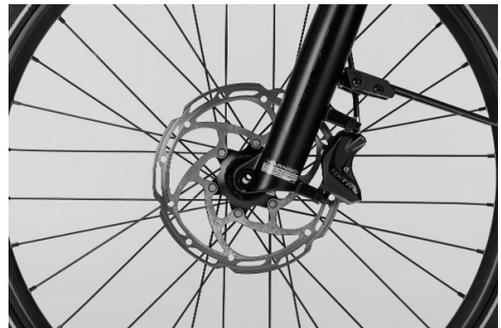
Abb. 1: Bremsscheibe am Vorderrad
