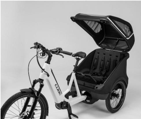
Abb. 20: Verdeck geöffnet, Trittbrett eingeklappt
