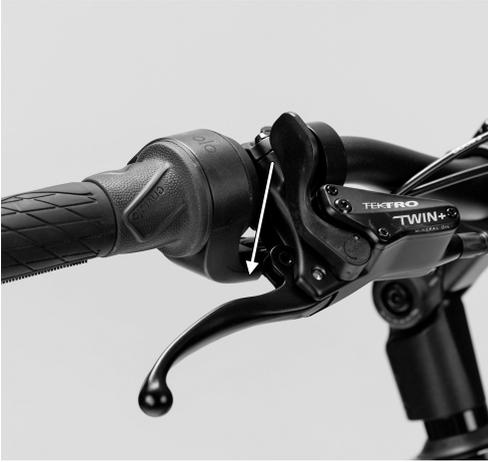
4. → Drehen Sie den Hebel so weit, bis ein Klicken zu hören ist und er einrastet. Der kleinere Hebel springt dabei vom größeren Hebel weg und arretiert diesen.
