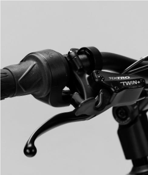
5. → Ziehen Sie den Bremshebel zum Lenker, bis Sie mehrfach ein Klicken hören.
