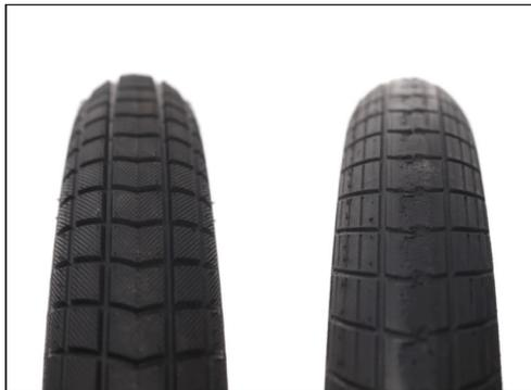
Abb. 8: optimales Reifenprofil (links); abgefahrenes Reifenprofil (rechts)
