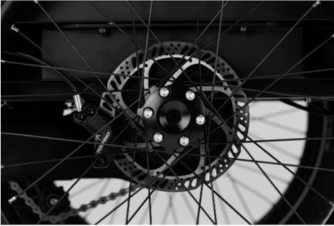
Abb. 2: Bremsscheibe am Hinterrad
