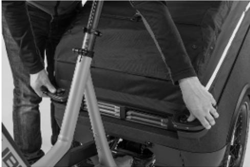
Abb. 41: gedrückte Knöpfe - Verdeck leicht geöffnet
