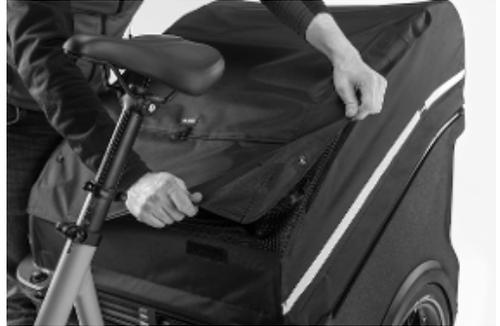
Abb. 53: Klettverschluss der Plane lösen
