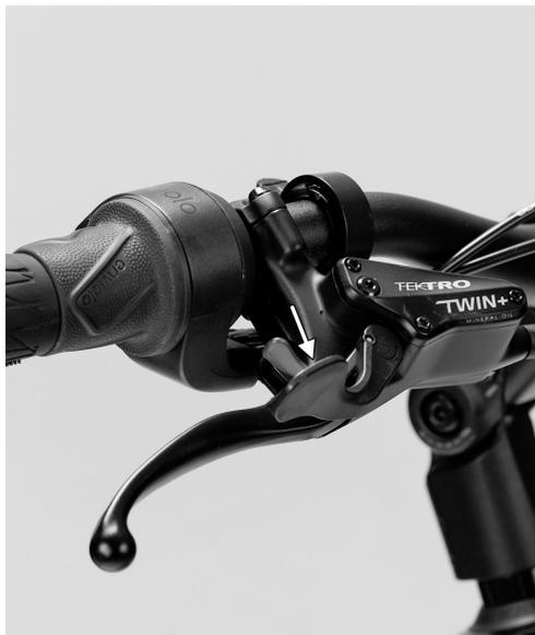
2. → Zum Einklappen, ziehen Sie beide Hebel vollständig in Richtung Lenker zurück.
