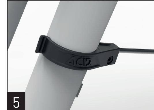
5. Stecken Sie die Gabel-Adapter (je mit Seitenmarkierung versehen!) auf die Strebe und fixieren Sie diese mit der M4x12mm Schraube und M4 Mutter. Fixieren Sie die Gabeladapter je mit den mitgelieferten O-Ringen an den Gabelholmen.
