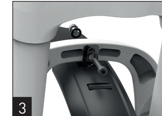
3. Befestigen Sie das Schutzblech mit der mitgelieferten M6x35mm Schraube, zwei M6 Unterlegscheiben und der M6 Mutter an der Gabelbrücke.
