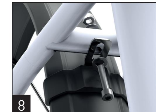
8.2 Setzen Sie den Brücken-Adapter auf das Schutzblech und verschrauben Sie diesen an der Sitzstrebengelenkbrücke mit der M5x25mm Schraube, der beiden M5 Unterlegscheiben und der M5 Mutter.
