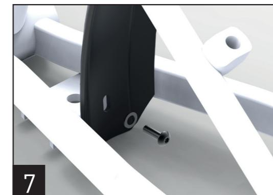
7. Befestigen Sie das Schutzblech mit der mitgelieferten M5x18mm Schraube und M5 Unterlegscheibe an der Kettenstrebenbrücke.
