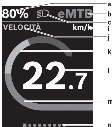
**a** Livello di carica della batteria della eBike (configurabile)
