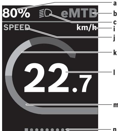
**a** Az eBike-akkumulátor töltöttségi állapota (konfigurálható)
