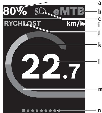
a Stav nabítky akumulátoru eBike (lze nakonfigurovat)
