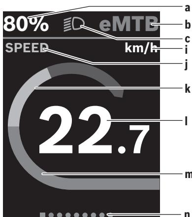
**a** Nivel de încărcare a acumulatorului eBike (configurabil)
