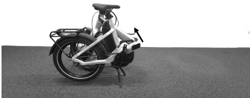
Abb. 6: vorderes Rahmenteil schwenken (schließen)
