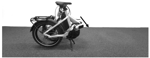
Abb. 11: vorderes Rahmenteil schwenken (öffnen)
