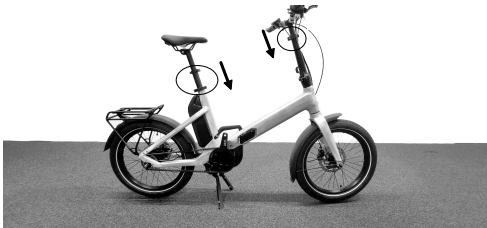
Abb. 2: Sattelstütze + Vorbau einfahren
