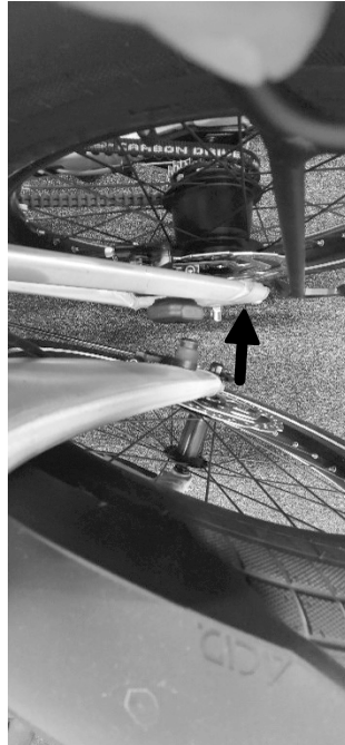
Abb. 7: Klickfix Quadlock Adapter schließen
