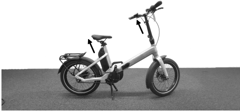
Abb. 15: Vorbau- und Sattelhöhe einstellen
