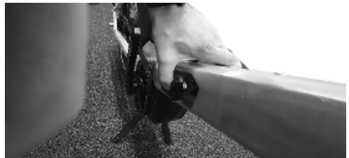
Abb. 13: Faltmechanismus durch Einrasten des Hebels in den Kugelkopf verriegeln
