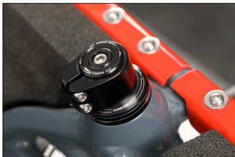
Bild: Steuersatz an der Gabelschaftklemmung
