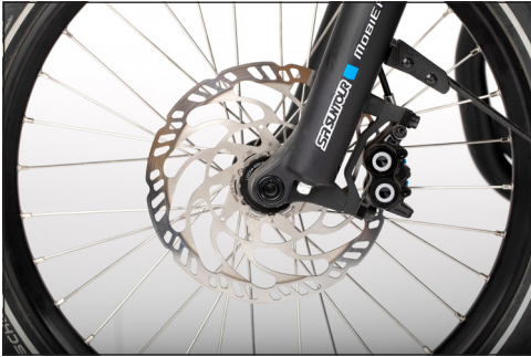
Bild: Bremscheibe am Vorderrad
