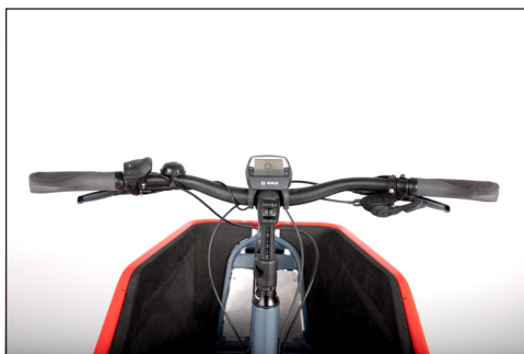
Bild: Lenker mit Lenkervorbau (inkl. Speedlifter)
