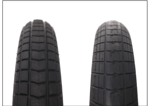
Bild: optimales Reifenprofil (links); abgefahrenes Reifenprofil (rechts)
