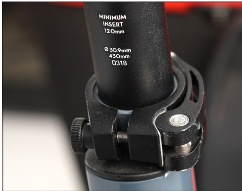
Bild: Markierung für die Mindesteinstecktiefe der Sattelstütze
