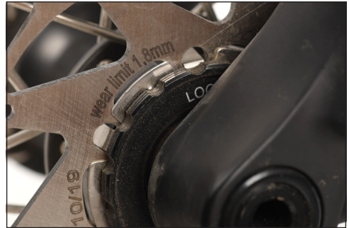
Bild: Angabe zur minimalen Dicke auf der Brems-scheibe (1,8 mm)
