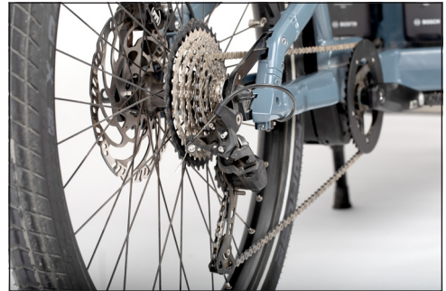
Bild: Zahnkränze mit Schaltwerk am Hinterrad
