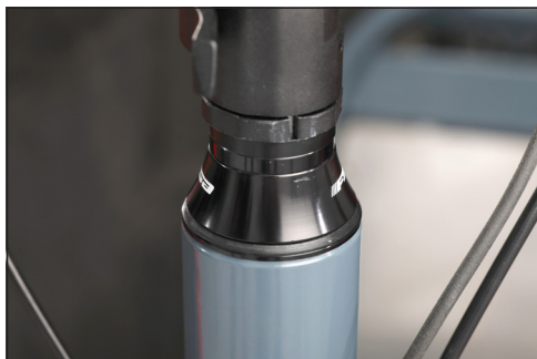
Bild: Steuersatz am Lenker
