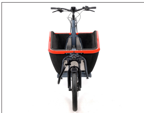
Bild: Lenkervorbau und Lenker korrekt ausgerichtet
