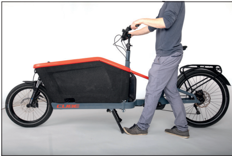
Bild: Ständer ausklappen
