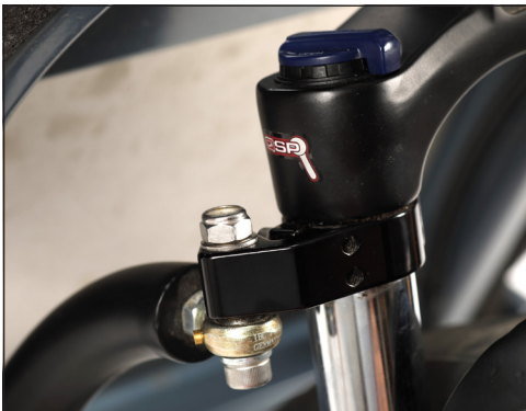
Bild: Drehpunkte der Lenksbaugruppe
