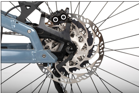
Bild: Bremscheibe am Hinterrad
