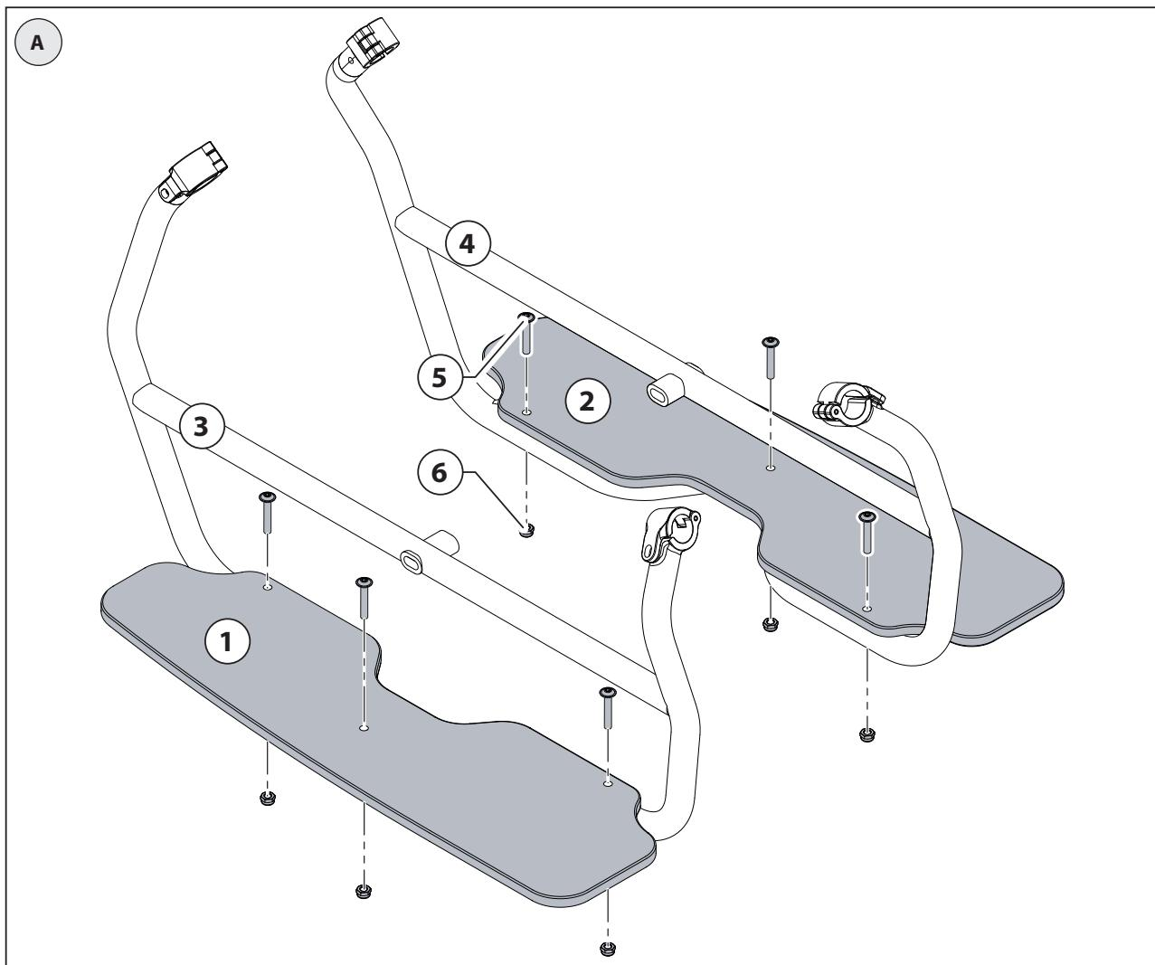
**B** Montierte Produkte rechts bzw. links am Gepäckträger anbringen.
