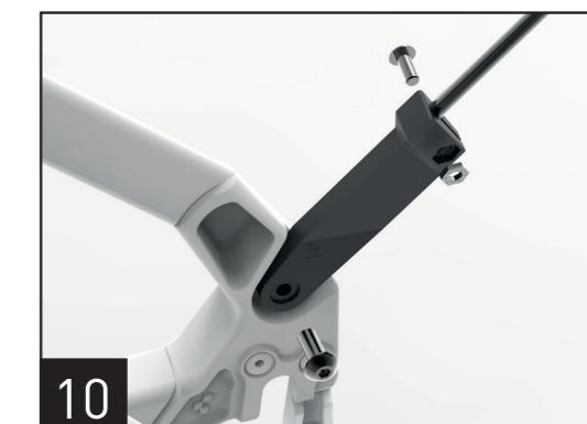
10. Stecken Sie die hinteren Streben-Adapter auf die Strebe und fixieren Sie diese mit der M4x6mm Schraube und M4 Mutter. Verschrauben Sie anschließend die Streben-Adapter mit der M5x12mm Schraube mit dem Rahmen am dafür vorgesehenen Gewinde. (Nur bei Set mit Streben!).
