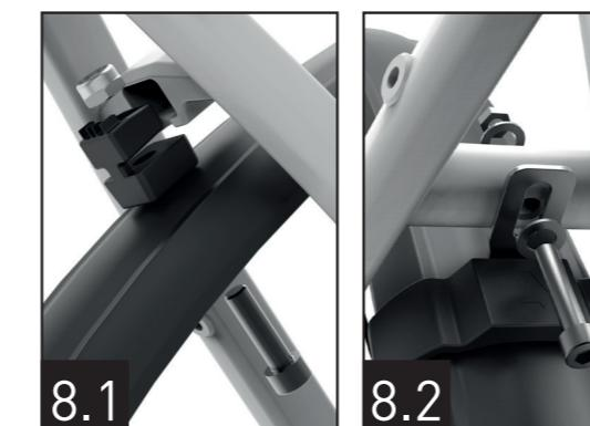
8.1 Bohren Sie mittig an der Brücken-Position ein Loch mit einem 7mm Bohrer. Setzen Sie den CUBE-Einsatz-Adapter mit der M6 Mutter in die Brückenaussparung. Setzen Sie nun von unten die mitgelieferte M6x22mm Schraube ein und ziehen Sie diese fest.
