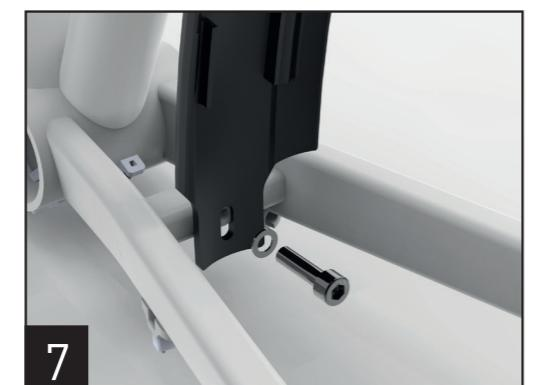
7. Befestigen Sie das Schutzblech mit der mitgelieferten M5x20mm Schraube und M5 Unterlegscheibe an der Kettenstrebengelenk.
