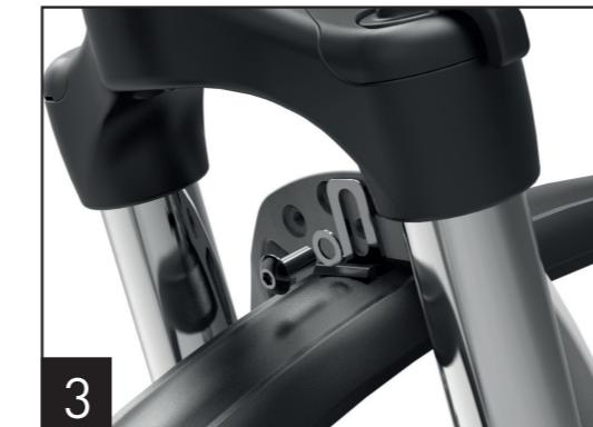
3. Befestigen Sie das Schutzblech mit der mitgelieferten M6x10mm Schraube und M6 Unterlegscheibe (oder M5x30mm Schraube mit M5 Mutter und Unterlegscheiben M5) an der Gabelbrücke.
