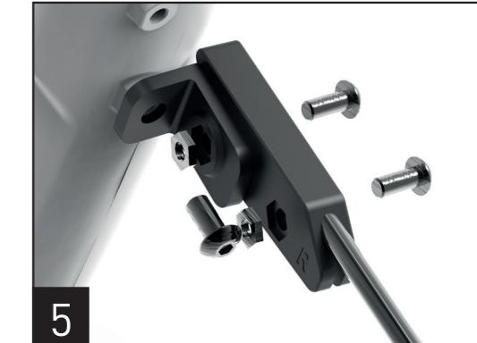
5. Stecken Sie den Gabel-Adapter auf die Strebe und fixieren Sie diese mit der M4x10mm Schraube und M4 Mutter. Schrauben Sie den L-Winkel mit der M5x10 Schraube an das dafür vorgesehene Gewinde an der Gabel und Verbinden Sie den Gabel-Adapter mit dem L-Winkel mit der M4x14mm Schraube und M4 Mutter. (Nur bei Set mit Streben!).
