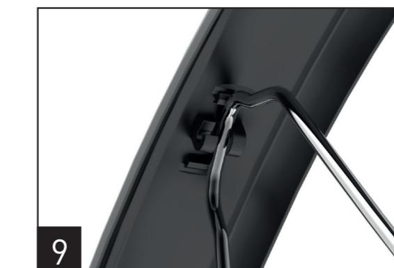
9. Setzen Sie die Strebe mittig von innen in den Streben-Adapter. Durch 90 Grad drehen rastet die Strebe im Streben-Adapter ein. (Nur bei Set mit Streben!).
