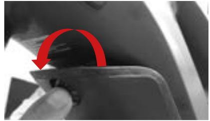
Drücken Sie den Druckknopf (Abb. 02), um die PowerTube Akkuabdeckung zu lösen. Entfernen Sie anschließend die Akkuabdeckung in dem Sie diese nach vorne aus den Rahmen ziehen (Abb. 03). Das Abnehmen der Akkuabdeckung ist aufgrund der beiden angebrachten Haltenasen (Abb. 04) ausschließlich nach vorne wie in (Abb. 03) gezeigt möglich.
