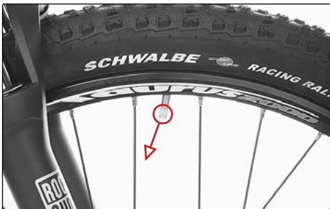
Ventil zeigt nicht zum Laufradmittelpunkt
