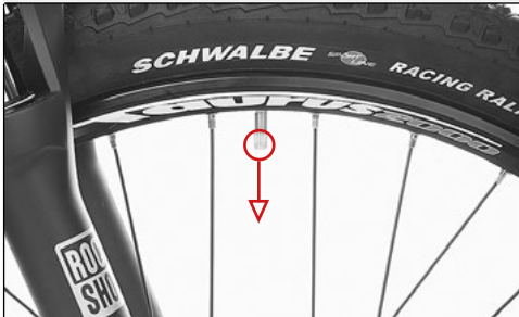
Ventil zeigt zum Laufradmittelpunkt
