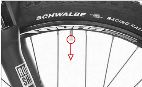
Ventil zeigt zum Laufradmittelpunkt
