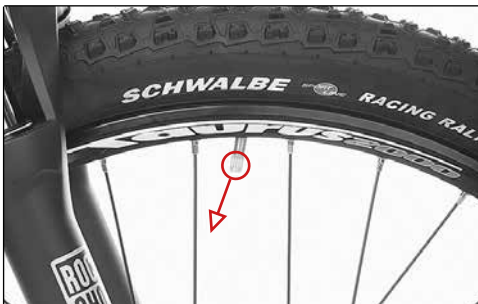
Ventil zeigt nicht zum Laufradmittelpunkt
