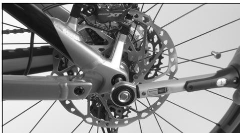
4. Per lo smontaggio occorre svitare il perno passante con una brugola.
