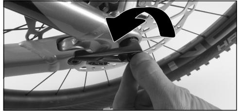
4. Se si è stretto l'asse in modo insufficiente, portare la leva in una posizione rivolta in avanti, nel senso di marcia, e spingere la leva sull'asse. Girare ora la vite di sicurezza di 180° in senso orario per impedire che la leva ruoti da sola.
