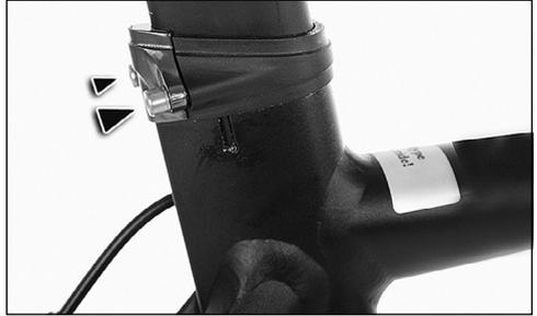
Per il serraggio senza leva a sgancio rapido, è necessario usare una chiave a brugola e una chiave dinamometrica per ciascuna delle dimensioni. A tal proposito consultare anche il proprio rivenditore specializzato.
