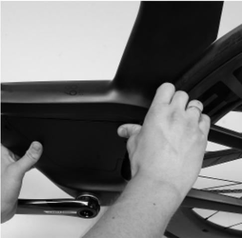
7. → Verbauen Sie den benötigten Deckel am Oberrohr, je nach gewählter Setup-Variante.
