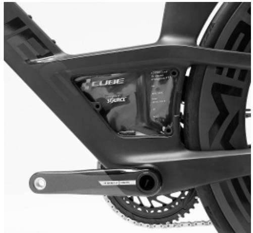
6. → Schließen Sie die Abdeckung der In-Frame Hydration am Tretlager.
