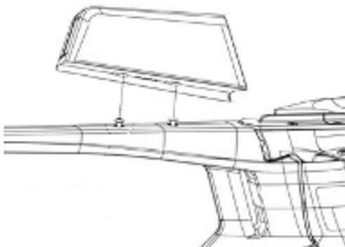
2. Schieben Sie das Storage-Box wie abgebildet nach vorne (Richtung Cockpit), bis die Schraubenköpfe in den vorgesehenen Schlitz einrasten (1).
