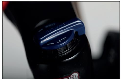
**Bild:** Suspension fork open (=OPEN)
