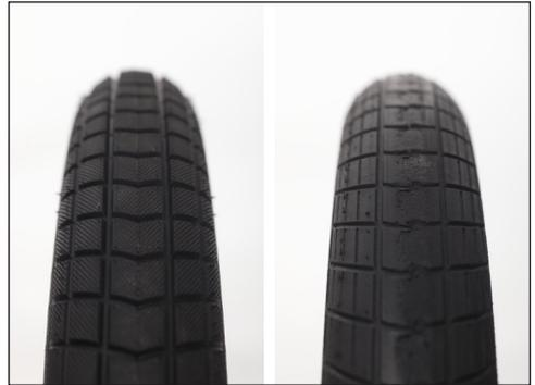
**Bild:** optimales Reifenprofil (links); abgefahrenes Reifenprofil (rechts)
