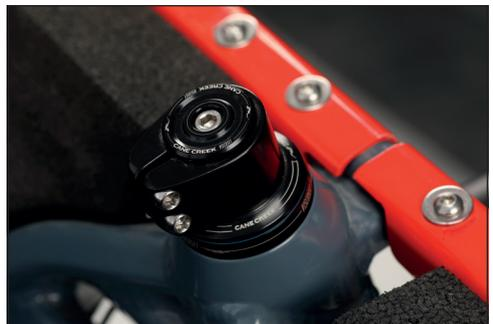
**Bild:** Head set on steerer tube clamp
