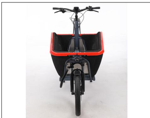
**Bild:** Lenkervorbau und Lenker korrekt ausgerichtet
