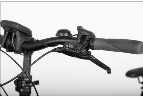
**Bild:** Bremshebel am Lenker
