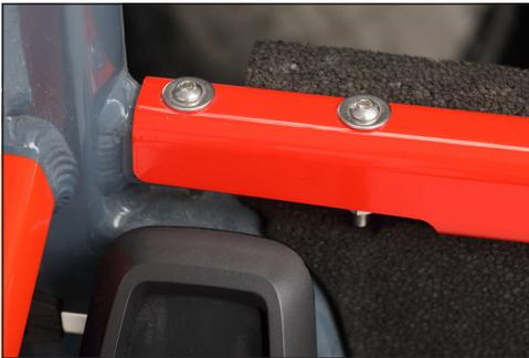
*Bild: Box-Verschraubungen vorne*
