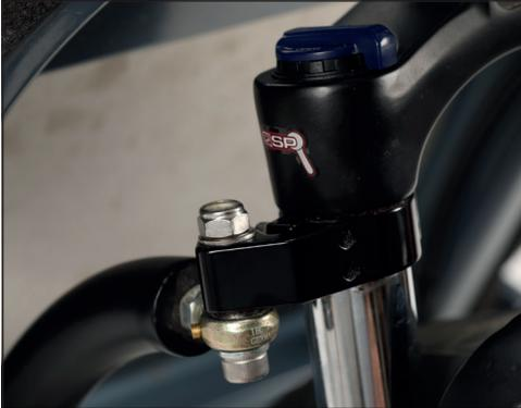
**Bild:** Pivot points of the steering assembly
