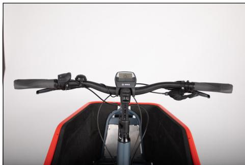
**Bild:** Lenker mit Lenkervorbau (inkl. Speedlifter)
