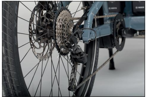
**Bild:** Sprocket with rear derailleur on rear wheel
