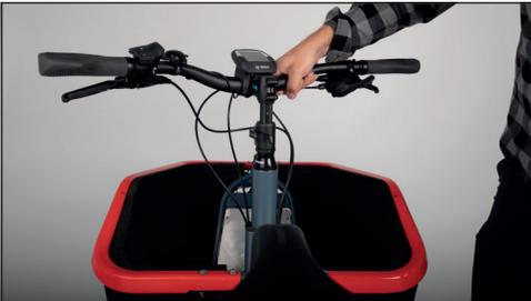
**Bild:** Handlebars height fixed
