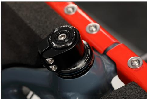
**Bild:** Steuersatz an der Gabelschaftklemmung
