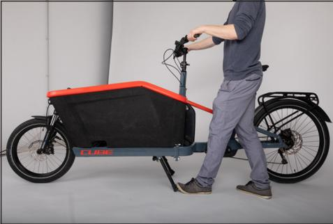
**Bild:** Ständer ausklappen
