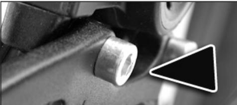
**Verschraubung, nicht korrekt** Eine lockere Schraube ist oft durch einen abstehenden Schraubenkopf erkennbar.
