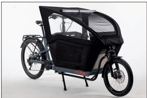
**Bild:** Rain cover mounted to the box
