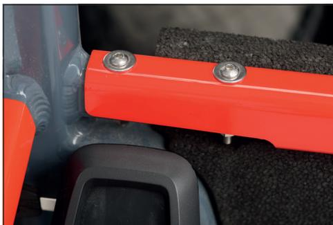
**Bild:** Front box screw connections
