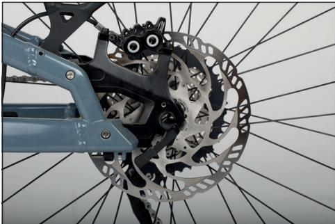
**Bild:** Brake disc on the rear wheel
