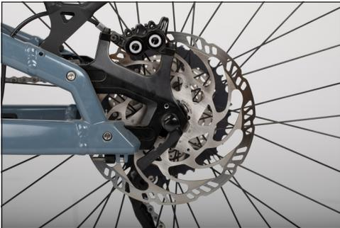
**Bild:** Bremsscheibe am Hinterrad
