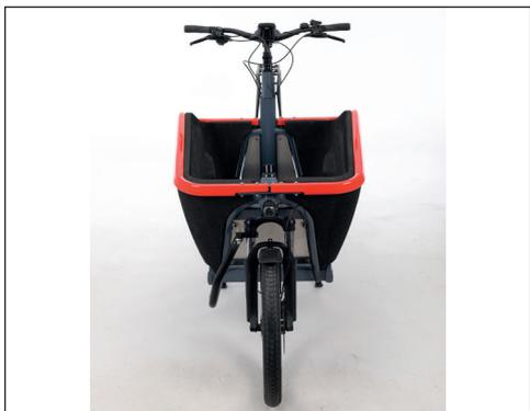
**Bild:** Stem and handlebars correctly aligned
