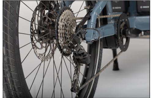
**Bild:** Zahnkränze mit Schaltwerk am Hinterrad
