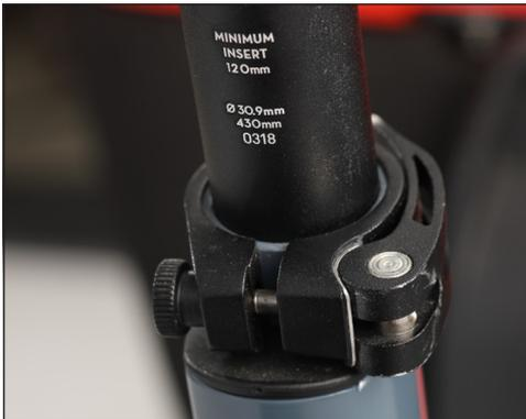
**Bild:** Markierung für die Mindesteinstecktiefe der Sattelstütze
