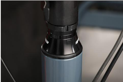
**Bild:** Steuersatz am Lenker
