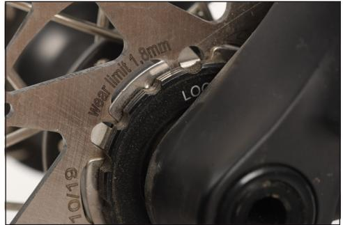
**Bild:** Angabe zur minimalen Dicke auf der Bremsscheibe (1,8 mm)
