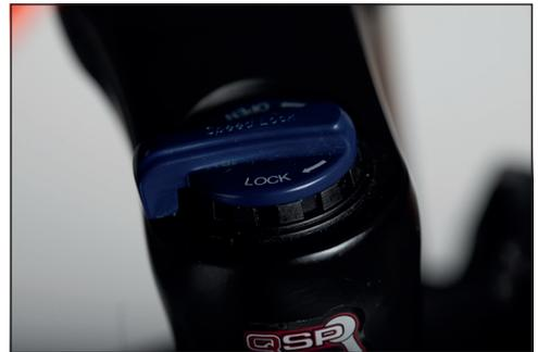
**Bild:** Suspension fork locked (=LOCK)
