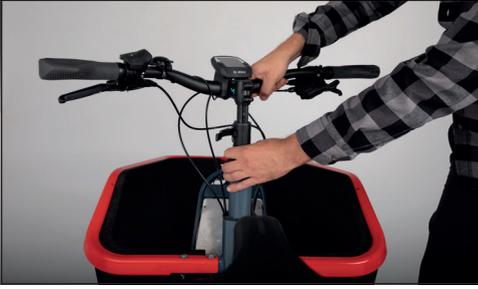
**Bild:** Adjusting the handlebar height
