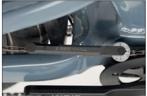
**Bild:** Chain wear gauge
